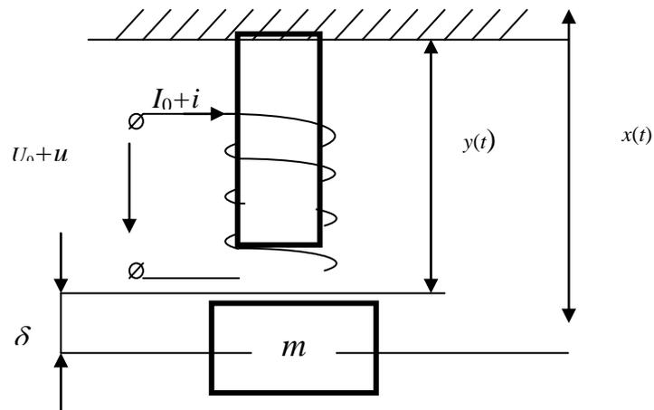
**Рис. 1.** Схема устройства с одномассовым электромагнитным подвесом.
