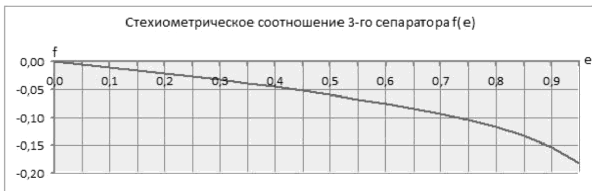
Рис. 5. График зависимости f(e) для третьего сепаратора при температуре T = -32,5 °С: f – отклонение от стехиометрического соотношения; e – доля отгона
