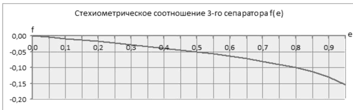
Рис. 4. График зависимости f(e) для третьего сепаратора при P = 6\,000\,000 Па: f – отклонение от стехиометрического соотношения; e – доля отгона
