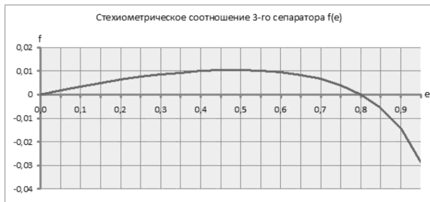
Рис. 3. График зависимости f(e) для третьего сепаратора при P = 5\,300\,000 Па: f – отклонение от стехиометрического соотношения; e – доля отгона
