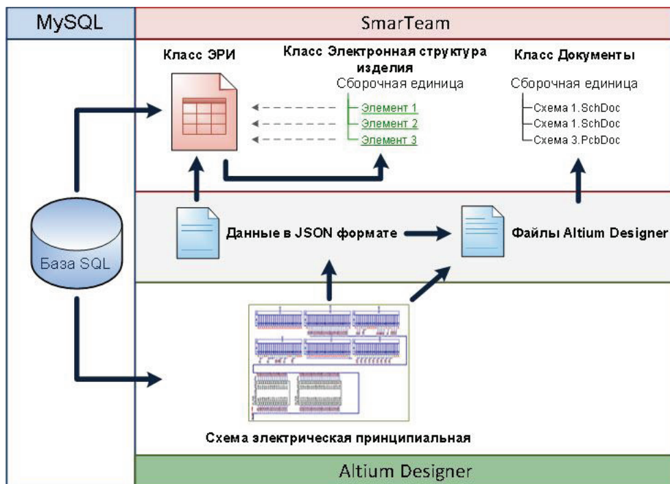
Рис. 1. Схема взаимодействия SmarTeam и Altium Designer
