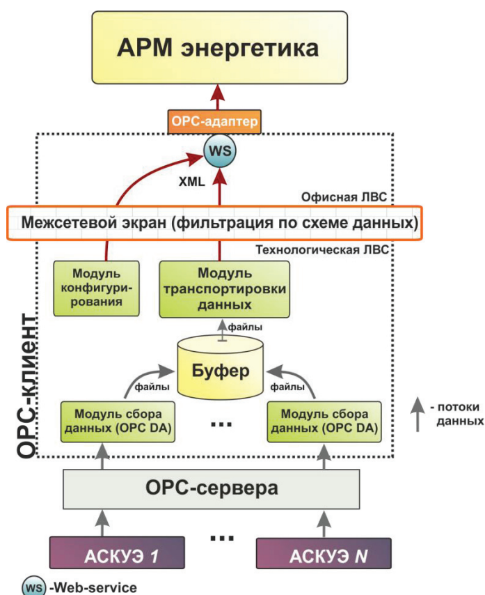
Рис. 6. Архитектура ПО разработанного OPC-клиента
