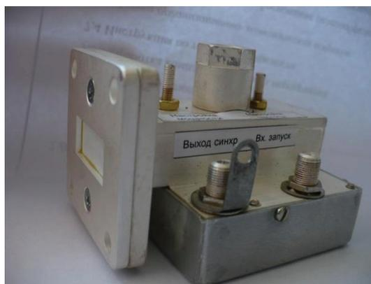
**Рис. 3.** Общий вид СВЧ генератора
