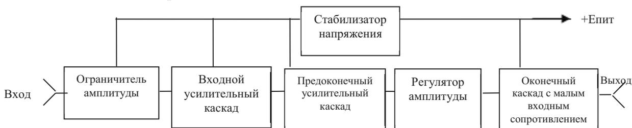
**Рис. 2.** Электрическая структурная схема узла формирования модулирующего сигнала
