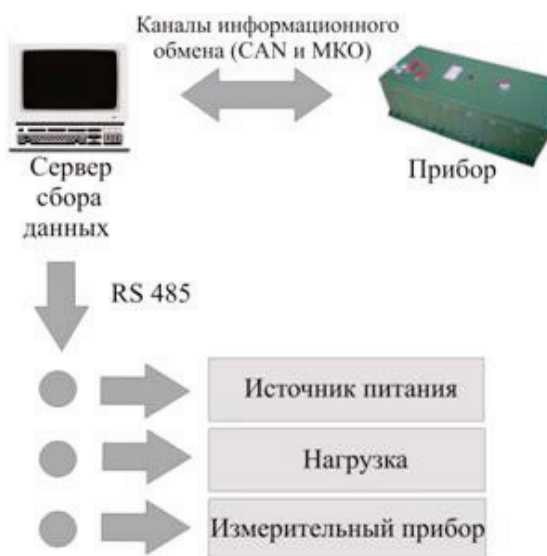
Рис. 2. Взаимодействие системы «Лотос» с аппаратной частью
