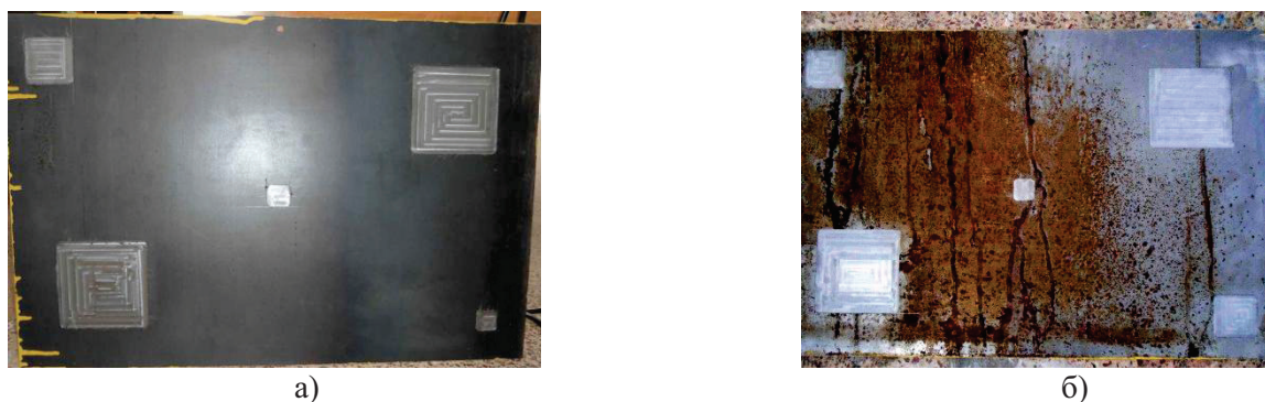
Рис. 1. Внешний вид стандартных образцов из стали со стороны искусственных дефектов – имитаций коррозии: а) пластина толщиной 1 мм; б) пластина толщиной 2 мм
