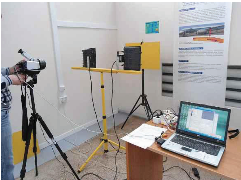
Рис. 6. Процедура АТНК при оптическом нагреве
