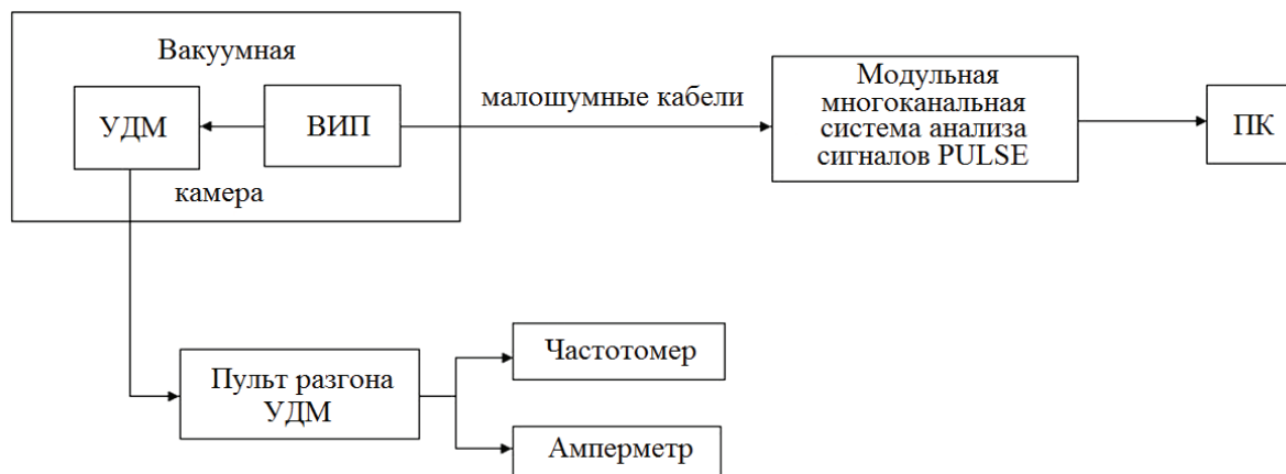
Рис. 1. Блок-схема стенда для проведения испытаний на определение вибрационных характеристик УДМ
