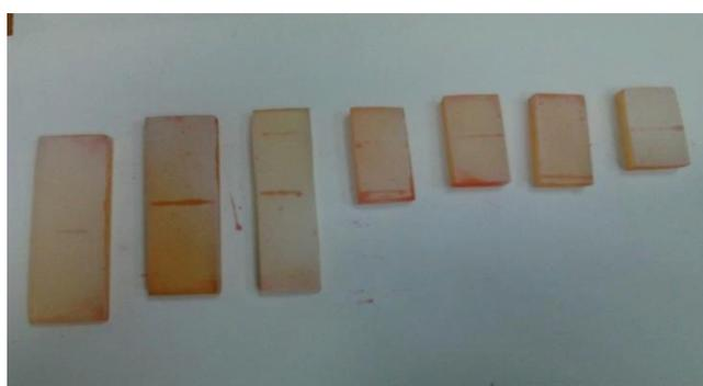
**Рис. 7.** Неметаллические образцы для капиллярного контроля
