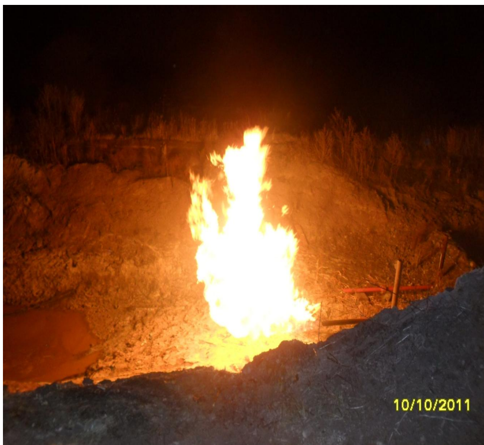
Рис. 2. Аварийный выброс газа из палеозойских отложений на Ново-Михайловской площади. Южно-Минусинская впадина. Хакасия
