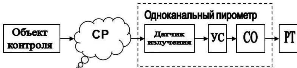
Рис. 1. Радиометрическая цепочка для одноканального пирометра: CP – среда распространения; УС – усилитель входного сигнала; СО – система обработки; РТ – температура в понятном для оператора коде
