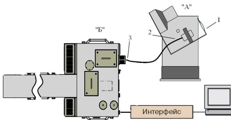
**Рис. 1.** Спектральный комплекс для измерения солнечного излучения
