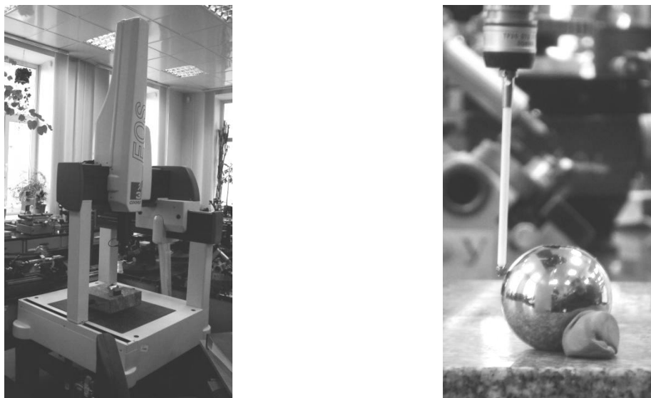
Рис. 7. Координатно-измерительная машина EOS Coord 3: а) общий вид; б) процесс измерения диаметра шарика
