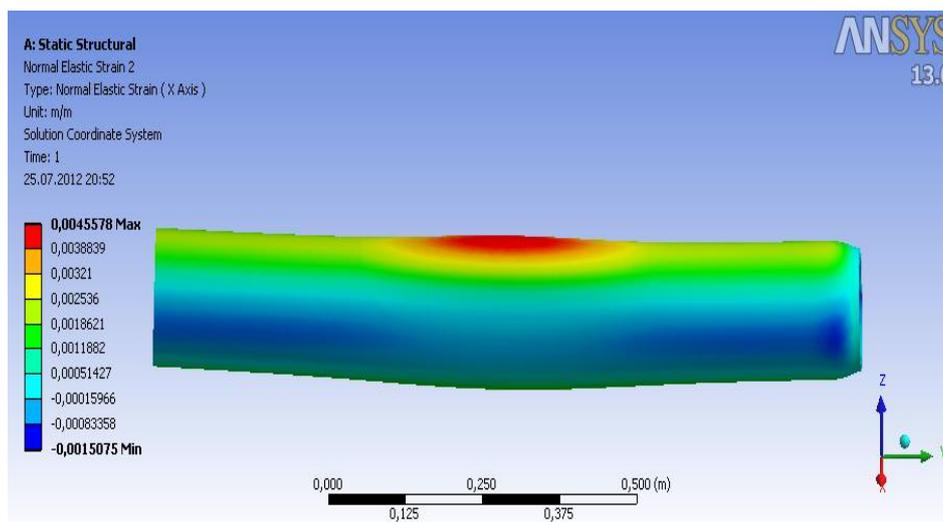
Рис. 7. Остаточная деформация дефектной трубы, вид сбоку
