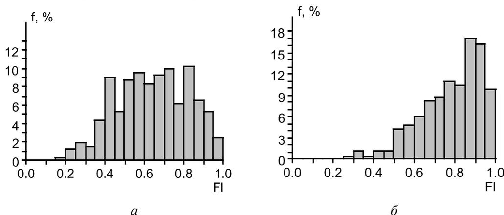
**Рис. 5.** Распределение частиц VC в зависимости от фактора удлинения ( $f$ ) в центре покрытий, выполненных током 260 А, при расходе 1,1 кг/ч (а) (средний фактор удлинения 0,64) и (б) при расходе 2,2 кг/ч (средний фактор удлинения 0,79)
