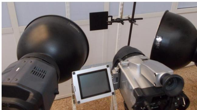
**Рис. 1.** Экспериментальная установка для активного теплового контроля
