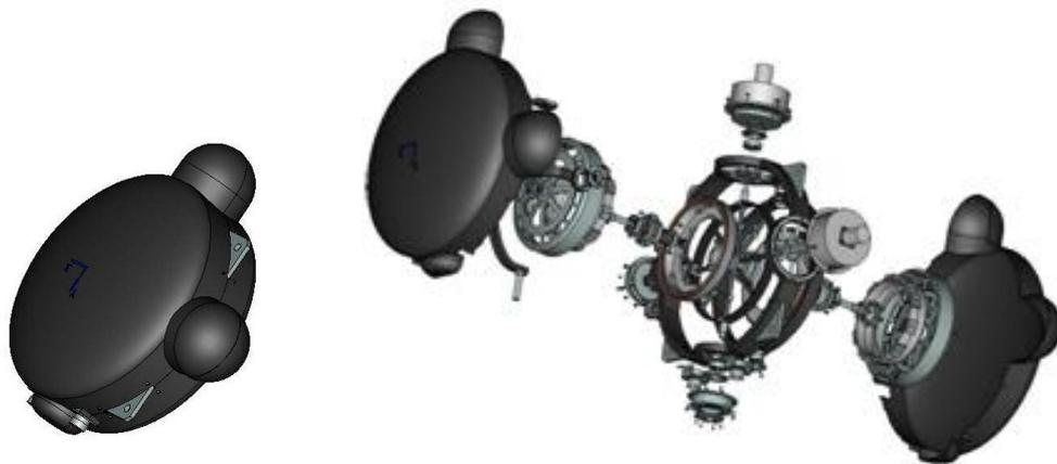
**Рис. 2.** Параметрическая 3D-модель гиродина
