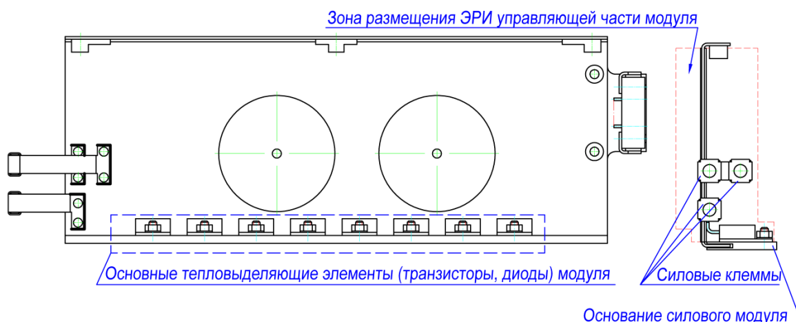
Рис. 2. Силовой модуль ЭПА КА
