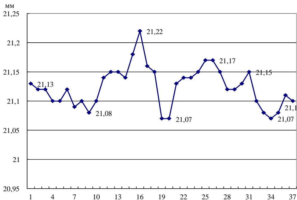
Рис. 6. Экспериментальным путем измерения внутреннего диаметра трубы 21 мм
