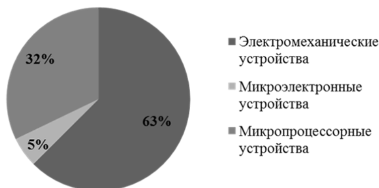
Рис. 1. Процентное соотношение УРЗА на электромеханической, полупроводниковой и микропроцессорной базе в операционной зоне Северокавказского РДУ
