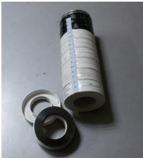
Рис. 9. Экранированная труба из лент аморфных магнитомягких сплавов
