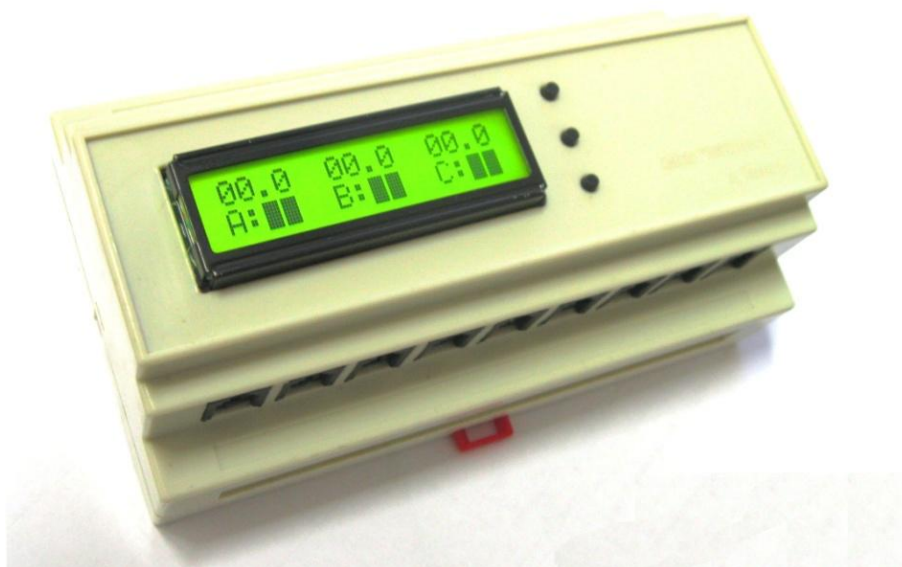
Рис. 4. Фотография устройства отключения неприоритетных нагрузок ООО «ЭКОЛАН» (г. Томск)
